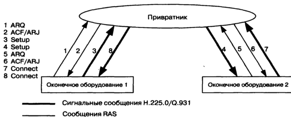
Рис. 6.9 Маршрутизация сигнальной информации привратником
